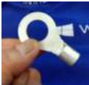
丸型端子に線を複数接続してカウンターポイズにします。
