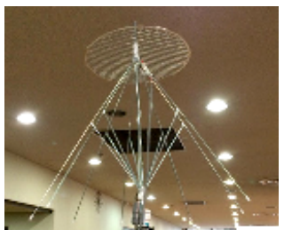
←100均のビニール傘で作ったディスコーンアンテナ。
